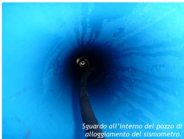
Sguardo all'interno del pozzo di alloggiamento del sismometro.
